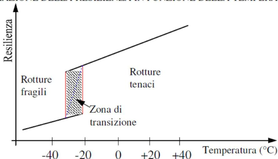
Convenzionalmente si definisce temperatura di transizione quella temperatura in corrispondenza della quale la resilienza con provetta con intaglio a V passa attraverso il valore di 35 J.
