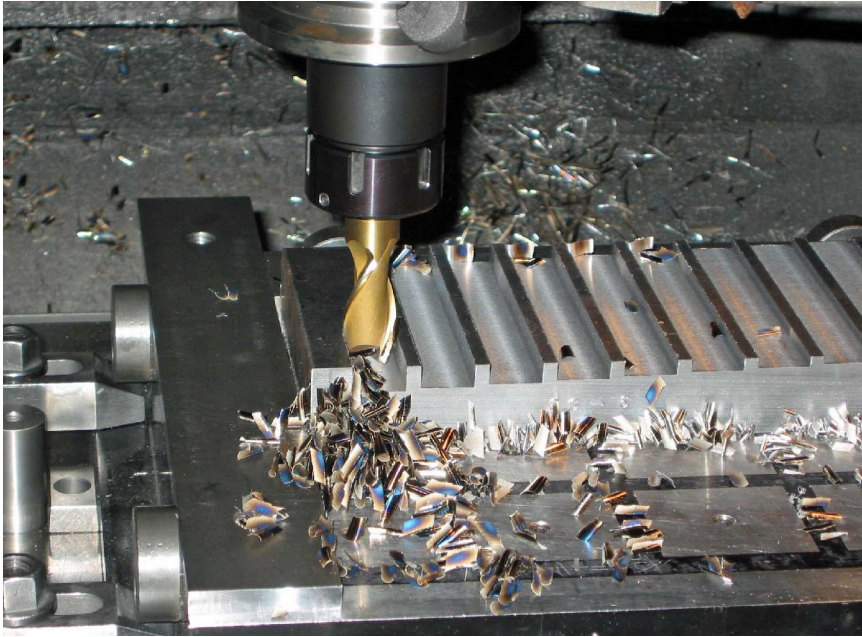
Creazione di alette tramite fresa cilindrica
