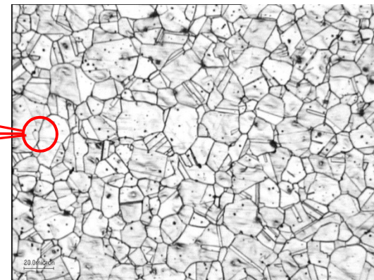
Microstruttura a grani (scala: 10^{-6} m)
