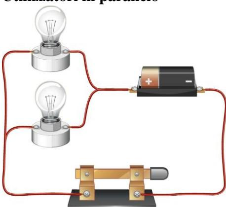
Senza utilizzare formule, possiamo dire che la corrente ha due vie di passaggio di uguale resistenza quindi la resistenza complessiva delle due lampadine collegate in parallelo è inferiore rispetto a quella di una sola lampadina. In base alla prima legge di Ohm, la corrente aumenta ma si suddivide fra le due lampadine. In definitiva ciascuna delle due lampadine produrrà la stessa luminosità di un circuito con una sola lampadina ma la batteria durerà la metà.
