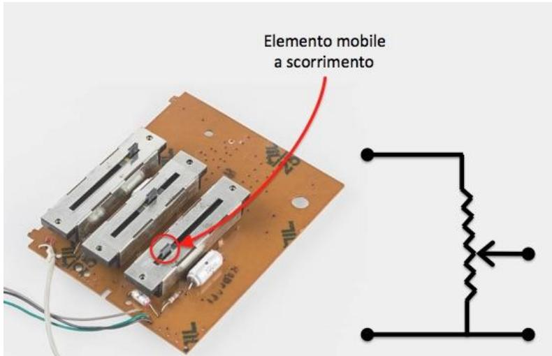
Ai capi della resistenza , a sinistra, si applica una differenza di potenziale  $V_{in}$ . Ai morsetti di destra si ottiene una differenza di potenziale  $V_{out}$ .
