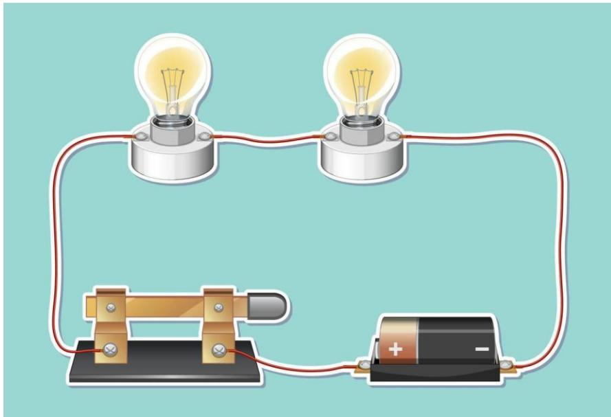
In questo circuito, le resistenze delle due lampadine si sommano, nel caso di lampadine uguali, la resistenza del circuito raddoppia, quindi, sempre in base alla prima legge di Ohm, la corrente diventa la metà. Ciascuna delle due lampadine sarà meno luminosa rispetto a quella di un circuito con una sola lampadina. La batteria si scaricherà nel doppio del tempo.
