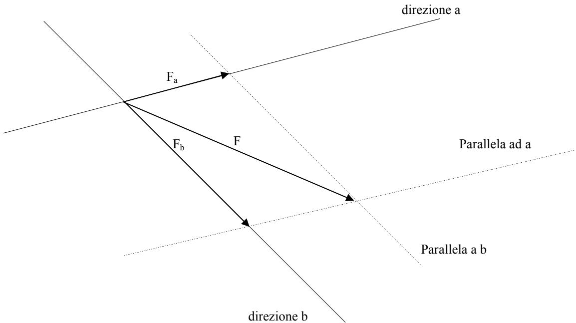
$F_a$  ed  $F_b$  rappresentano le componenti del vettore  $F$  lungo le direzioni  $a$  e  $b$ .
