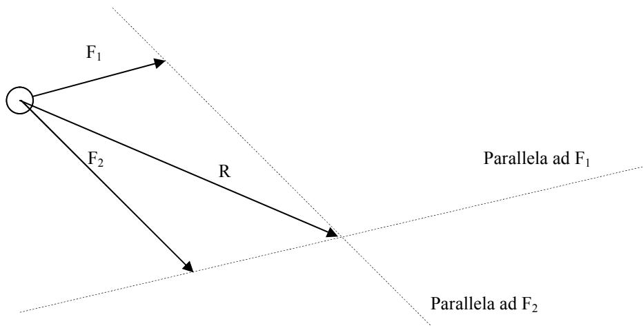
Questo schema si chiama **regola del parallelogramma**, l'operazione si chiama **somma dei vettori**, il vettore somma  $R$  si chiama **risultante dei vettori  $F_1$  ed  $F_2$** .
