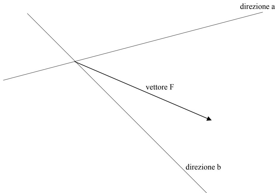
poi si applica la regola del parallelogramma al contrario cioè si parte dalla punta del vettore  $F$  che si intende scomporre e tracciano le parallele alle rette date  $a$  e  $b$  come nella figura sotto.
