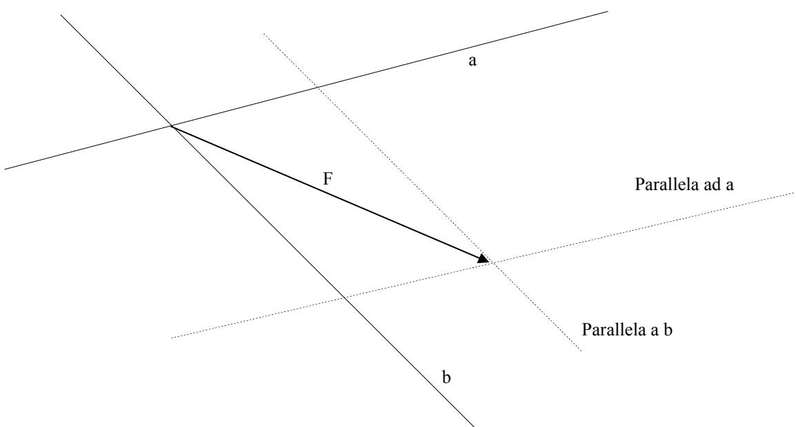
Infine, le componenti del vettore  $F$  si ottengono unendo il punto di applicazione del vettore  $F$  con l'incrocio delle rette  $a$  e parallela a  $b$  e poi  $b$  e parallela ad  $a$ . esattamente come nella figura sotto.
