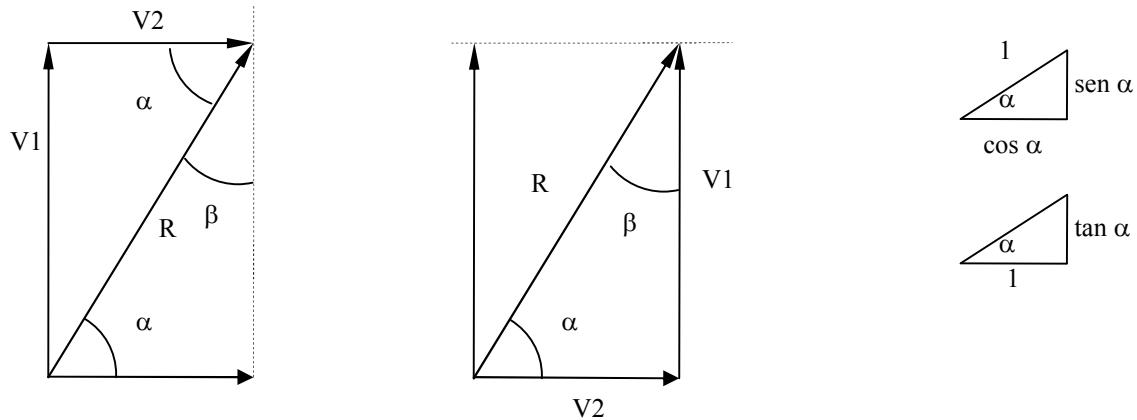
La costruzione grafica perviene ad un triangolo rettangolo del quale i cateti sono i due vettori da sommare  $V_1$  e  $V_2$  mentre l'ipotenusa è il vettore risultante  $R$ . Pertanto,
