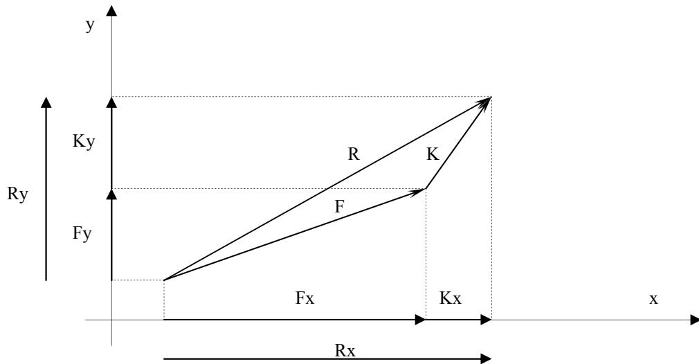
La somma vettoriale di  $F$  e  $K$  è la risultante  $R$ . Dalla figura sopra, eseguita la somma grafica si vede che le componenti della risultante  $R$  sono uguali alla somma delle componenti dei vettori  $F$  e  $K$  fatte lungo i rispettivi assi. Le componenti lungo l'asse  $x$  si sommano solo fra loro e così le componenti  $y$ :
