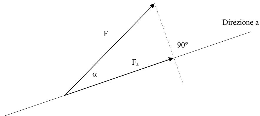
La componente di  $F$  nella direzione  $a$ , cioè  $F_a$ , è la forza che, lungo la direzione  $a$  produce lo stesso effetto della forza inclinata  $F$ . Si calcola con  $F_a = F \cos \alpha$
