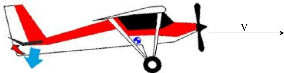
L'aeroplano della figura sotto si dirige verso sinistra ( vira verso sinistra ) Ha un peso  $W = 1700$  kg e nella virata è sottoposto ad una forza centrifuga  $F_c = 1426$  kg. Determinare la portanza in modulo direzione ( angolo rispetto alla verticale ) e verso.
