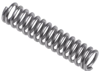
La grande deformazione di questo tipo di molla è dovuta alla torsione del filo di acciaio di cui è costituita. La torsione si ha in tutte le sezioni trasversali del filo. La piccola torsione nelle infinite sezioni del filo produce un grande spostamento di un'estremità rispetto all'altra. A parità di forza, la deformazione dovuta alla torsione del filo è enormemente superiore a quella che si avrebbe se il filo fosse tirato o compresso.
